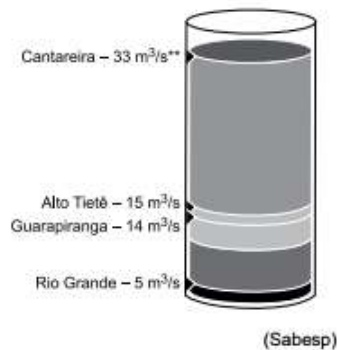
CAPACIDADE DE RETIRADA DOS SISTEMAS
