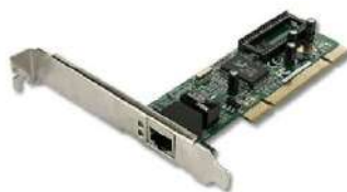
Placa de rede Ethernet (conector RJ45).
