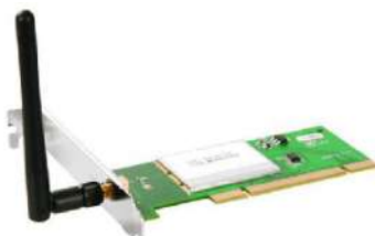
Placa de rede Wi-Fi (possui antena) – Assim como a Ethernet ela deve ser encaixada no barramento PCI da placa mãe.
